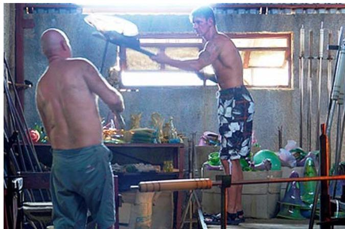
Ist das Werk gelungen, wird es von der Glasmacherpfeife abgenommen und über mehrere Stunden langsam von einer Temperatur um 800 Grad Celsius auf 150 Grad Celsius abgekühlt. Erst die anschließende Qualitätskontrolle wird zeigen, ob das Kunstwerk makellos ist.
